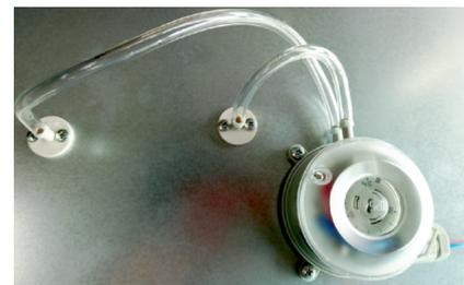
Man kann den Moment der Druckschalterbetätigung ändern (d. h. die Druckdifferenz hinter und vor dem Filter, bei der das Gerät den Filteralarm auslöst). Schrauben Sie dazu das obere Kunststoffgehäuse ab und ändern Sie die Einstellung mit einem Schlitzschraubendreher. Der vom Lieferanten vorgeschlagene Einstellwert beträgt 80- 100 Pa.
