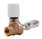
Stromversorgung/Frequenz: 230 V AC / 50 - 60 Hz Stromverbrauch: 2 VA Kvs-Koeffizient des Ventils: 6,3 m³/h Steigung des Einstellelements: 3 mm Betriebsbedingungen des Antriebs: -5°C - 60°C Öffnungszeit: 3 - 5 min Schutzklasse des Gehäuses: IP 54
